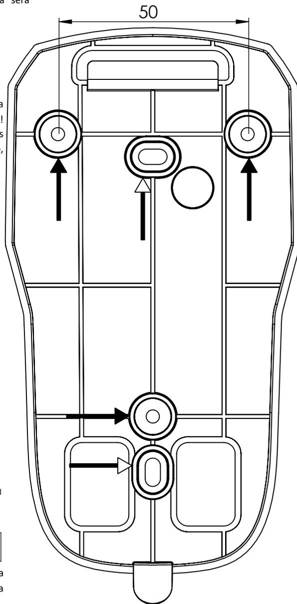
➔ Furos para fixação na parede
