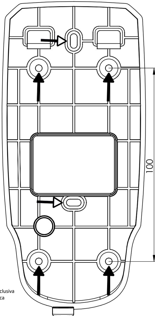
➡ Furos para fixação na parede
